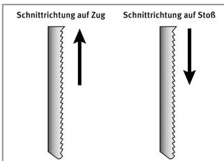
**Achtung:** Die Schnittrichtung des verwendeten Sägeblattes muss beachtet werden. Die Stichsägen können auf Zug (üblicher Fall) oder auf Stoß arbeiten.
