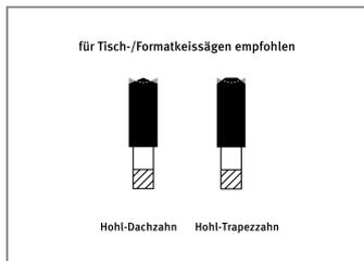
Für das Sägen der DecoWall Platten mit der Handkreissäge werden Sägeblätter mit Trapez-Flachzahn empfohlen. Für Tischkreissägen hingegen Sägeblätter mit Hohl-Dachzahn oder Hohl-Trapezzahn. Je feiner die Zähne sind, desto weniger Ausrisse treten auf. Im Vergleich zum Sägen von Massivholz sollte mit reduzierter Vorschubgeschwindigkeit gesägt werden.
